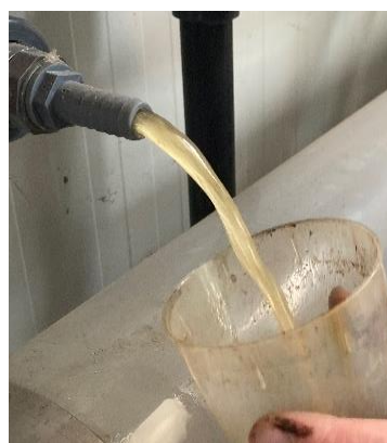
Fig. 23: primer clarificat, resultat de la ultrafiltració
